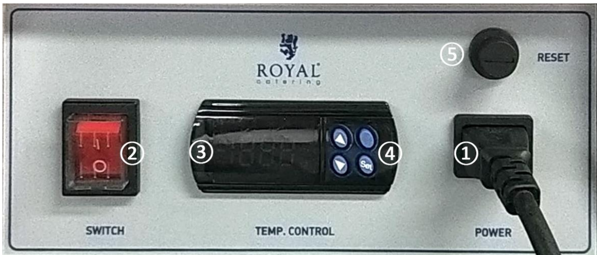
Figure 3 : Le panneau de réglage de la température
