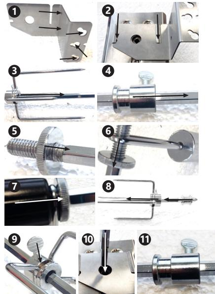
1. Con l'ausilio delle viti fissare la staffa di montaggio del motore al telaio/ girarrosto precedentemente preparato.
