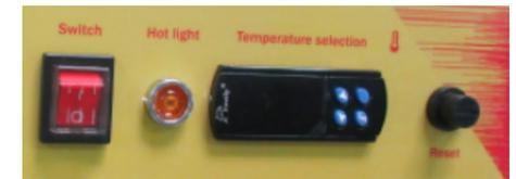
4. Drücken Sie die SET-Taste und stellen Sie dann mit den Pfeilen daneben die gewünschte Temperatur ein. Der Temperaturregler hat zusätzliche Funktionen. Drücken Sie gleichzeitig die SET-Taste und einen der Pfeile, um:
