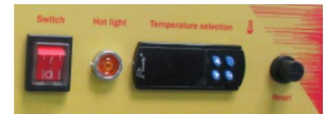
4. Appuyez sur le bouton SET, puis réglez la température souhaitée à l'aide des flèches situées à côté. Le thermostat possède des fonctions supplémentaires. Appuyez simultanément sur le bouton SET et sur l'une des flèches pour :
