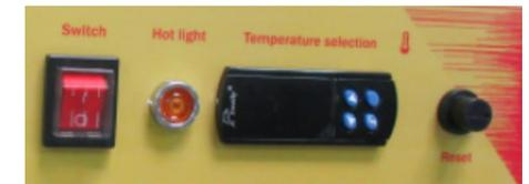
4. Nyomja meg a SET gombot, és a mellette lévő nyílakkal állítsa be a kívánt hőmérsékletet. A hőmérséklet-szabályozó további funkciókkal is rendelkezik. Nyomja meg egyszerre a SET gombot és az egyik nyílat, hogy:
