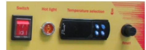
4. Stiskněte tlačítko SET a poté nastavte požadovanou teplotu pomocí šipek umístěných vedle. Termoregulátor má další funkce. Stiskněte současně tlačítko SET a jednu ze šipek pro:
