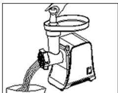
Installation de l'appareil avec l'embout à farcir
