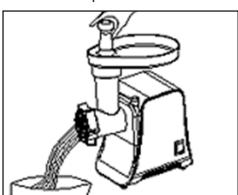
Instalación del dispositivo con el accesorio para salchicha
