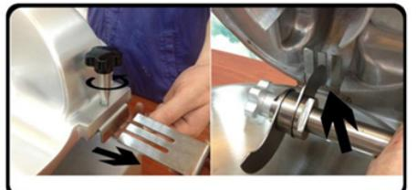
Desenrosque la perilla que asegura el divisor de bloqueo y retírela. Al montarlo, asegúrese de que esté inclinado hacia abajo y que entre exactamente en su lugar. Fíjelo en su lugar usando la perilla correspondiente. Finalmente, asegúrese de que la hoja de la cuchilla pase suavemente a través de las ranuras que se encuentran en el divisor, es decir, no se producen摩擦es ni bloques.
