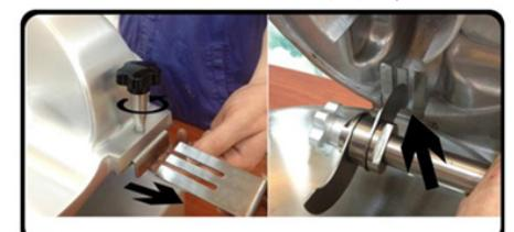
Odsroubkujte upevnovačí knoflík blokovací přepážky a poté vytáhněte přepážku ven. Při její montáži je třeba se ujistit, že je nakloněna směrem dolů a úplně zapadla na svoje místo. Poté ji upevněte na svém místě pomocí knoflíku. Na závěr se ujistěte, že čepel nože hladce prochází šterbinami v přepážce – tzn. o nic se neotírá nebo ani ji níc nepřekáží.
