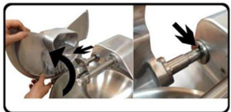
Abra la tapa del plato levantándola a la posición vertical usando la palanca roja, y sáquela con cuidado para que el pasador de su eje pase suavemente a través de los agujeros. Al volver a instalarla, asegúrese de que su eje esté insertado hasta final y que pueda levantarse fácilmente a la posición vertical.
