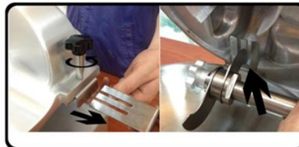
Svitare la manopola che fissa il divisorio di bloccaggio e quindi tirare quest'ultima verso l'esterno. Durante il fissaggio, assicurarsi che essa sia inclinata verso il basso e che sia completamente inserita al suo posto. Quindi fissarla in posizione mediante la rispettiva manopola. Successivamente, assicuratevi che la lama del coltello passi senza problemi attraverso le fessure del divisorio - cioè non strofini o blocchi.
