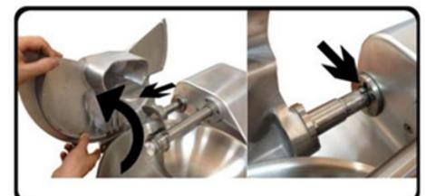
Öffnen Sie die Tellerabdeckung, indem Sie sie mit dem roten Hebel in eine aufrechte Position anheben und dann vorsichtig abziehen, so dass der Bolzen auf der Achse reibunglos durch die Öffnung läuft. Stellen Sie beim Zusammenbau sicher, dass die Achse vollständig eingesetzt ist und leicht in die vertikale Position angehoben werden kann.
