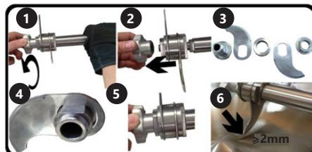
Nejprve je třeba otevřít víko talíře a v případě potřeby talíř demontovat (dle výše uvedených bodů). Dlaní nebo pomocí náradí zajistěte hřídel nože. Odšroubujte držák hřidele nože a odstraňte části nože z jeho základny. Pokud je nutné nastavit vzdálenost mezi nožem a talírem, použijte nářadí a povolte matici. Správná vzdálenost mezi čepelemi nože a talírem by měla být 2 mm nebo více. Při správném namontování by mezi základnou nože a je hlavní hřidel neměl být žádný volný prostor.
