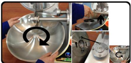
Öffnen Sie die Tellerabdeckung und drehen Sie den Teller dann in einem bestimmten Winkel im Uhrzeigersinn, bis sie sich locker anfühlt. Dann heben Sie sie ein wenig an und ziehen sie heraus. Stellen Sie beim Einbau sicher, dass sie in der Halterung einrastet, indem Sie sie gegen den Uhrzeigersinn drehen, bis sie nicht mehr weiter gedreht werden kann.
