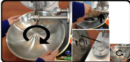
Abra la tapa del plato, gire el plato en el sentido de las agujas del reloj y en un ángulo adecuado, hasta que se afloje. A continuación, levántelo suavemente y retírelo. Al colocarlo de nuevo, asegúrese de que encaje en el soporte girándolo en sentido contrario a las agujas del reloj, hasta que no pueda girar más.
