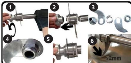
Pour commencer, ouvrez le couvercle de l'assiette, si nécessaire, retirez l'assiette elle-même (voir les points ci-dessus). Verrouillez l'arbre porte-lame avec votre main ou avec des outils appropriés. Dévissez le manche l'arbre porte-lame et retirez les éléments de la lame de la base.
