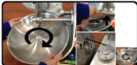
Ouvrez le couvercle de l'assiette, puis tournez l'assiette dans le sens des aiguilles d'une montre jusqu'à ce qu'elle se desserre. Ensuite, soulevez légèrement le couvercle et retirez-le. Lorsque vous montez à nouveau le couvercle, veillez à ce qu'il rentre dans le support en tournant dans le sens inverse des aiguilles d'une montre jusqu'à ne plus pouvoir tourner.
