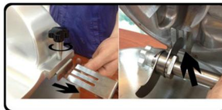
Odkręcić pokrętło mocujące przegrodę blokującą i następnie wyciągnąć przegrodę na zewnątrz. Mocując ją należy upewnić się, że jest pochylona w dół i całkowicie weszła w swoje miejsce. Wtedy zamocować ją na miejscu za pomocą jej pokrętla. Po wszystkim upewnić się, że ostrze noża przechodzi gładko przez szczelinę w przegrodzie – tj. nic nie ociera, czy blokuje.
