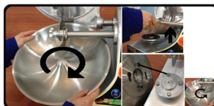
Otworzyć pokrywę talerza, a następnie obrócić talerz pod pewnym kątem w kierunku wskazówek zegara, aż poczuje się, że jest luźna. Wtedy nieco ją unieść i wyciągnąć. Montując ją z powrotem należy zwrócić uwagę, aby wskoczyła w mocowanie obracając ją w kierunku przeciwnym do wskazówek zegara do momentu aż nie da się dalej obracać.
