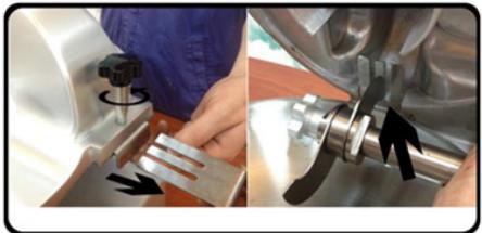
Öffnen Sie die Tellerabdeckung, indem Sie sie mit dem roten Hebel in eine aufrechte Position anheben und dann vorsichtig abziehen, so dass der Bolzen auf der Achse reibungslos durch die Öffnung läuft. Stellen Sie beim Zusammenbau sicher, dass die Achse vollständig eingesetzt ist und leicht in die vertikale Position angehoben werden kann.
