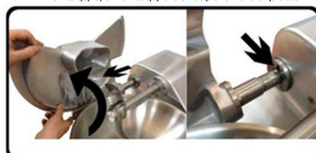
Inclinare il coperchio del piatto sollevandolo con la leva rossa in posizione verticale e poi tirarlo con cautela in modo che il perno sul suo asse attraversi dolcemente i fori. Al momento del rimontaggio, assicurarsi che il suo asse abbia raggiunto l'estremità e possa essere facilmente sollevato in posizione verticale.
