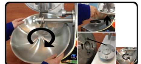
Otevřete víko talíře a poté otočte talíř pod určitým úhlem ve směru pohybu hodinových ručiček, až se uvolní. Poté ho trochu nadzvedněte a vytáhněte. Při zpětném montáži je třeba dát pozor, aby zapadl do držáku, pak nim otáčejte proti směru hodinových ručiček, dokud se nezastaví a nebude s ním možné otáčet.
