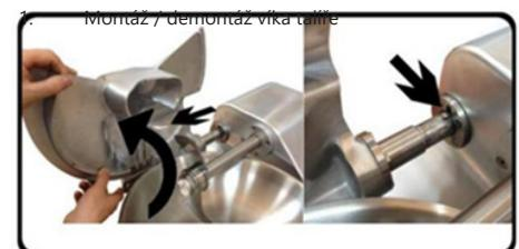
Otevřete víko talíře zvednutím červené páky do svíslé polohy a opatrně jej stáhněte tak, aby čep na jeho ose prošel hladce otvory. Při zpětné montáži je třeba se ujistit, že jeho osa je zcela zasunutá a lze ji snadno zvednout do svíslé polohy.
