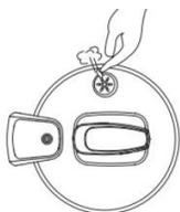
Öffnen Sie die Geräteabdeckung erst, wenn aus dem Sicherheitsventil kein Dampf mehr austritt. Fassen Sie den Deckel vorsichtig am Griff (die Metallteile der Abdeckung können heiß sein), drehen Sie ihn dann nach rechts und heben Sie ihn an.
