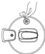
Pokrywę urządzenia otwierać dopiero w momencie, kiedy z zaworu bezpieczeństwa przestanie wydobywać się para. Należy ostrożnie chwycić pokrywę za uchwyt (metalowe części pokrywy mogą być gorące) i przekręcić w prawo oraz unieść do góry.
