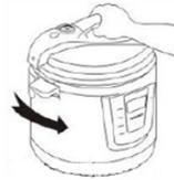
3. Mettez la soupape de sécurité en position „Close”.
