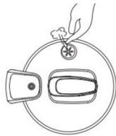
No abra la tapa del dispositivo hasta que ya no salga vapor de la válvula de seguridad. Sujete la tapa con cuidado por el mango (las partes metálicas de la tapa pueden estar calientes), luego gírela hacia la derecha y levántela.
