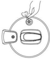
Víko zařízení otevřete teprve tehdy, když z pojistného ventilu přestane unikat pára. Opatrně uchopte víko a úchyt (kovové části víka mohou být horké) a otočte jej vpravo a zvedněte.
