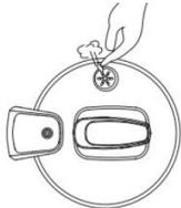
N'ouvrez le couvercle de l'appareil que lorsque la vapeur ne s'échappe plus de la soupape de sécurité. Tenez avec précaution le couvercle par la poignée (les parties en métal du couvercle peuvent être très chaudes), puis tournez-le vers la droite et soulevez-le.
