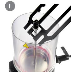
Rimuovere i fermagli di fissaggio del contenitore (6), muovere il contenitore facendolo ondeggiare e rimuoverlo:
