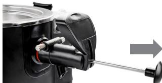
Desenrosque los dos tornillos (1) y extraiga el resorte (2) del orificio. Ya puede sacar completamente el grifo dispensador:
