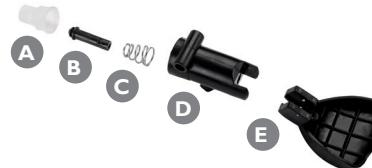
Die auf diese Weise ausgebauten Bestandteile können nun gereinigt und desinfiziert werden. Der Zusammenbau der gesäuberten und desinfizierten Bestandteile erfolgt in umgekehrter Reihenfolge. Dabei bitte folgendes berücksichtigen:
