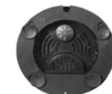
Les distributeurs RCSS-3 sont équipés d'un thermostat supplémentaire situé sous l'appareil. Celui-ci permet de réguler la température maximale de la plaque chauffante. Le thermostat est calibré avec les valeurs d'usine et ces réglages par défaut ne doivent pas être modifiés/altérés. La modification de ce réglage influence le temps de chauffe de la matière à chauffer.
