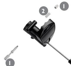
Desmontaje de la palanca de accionamiento:
