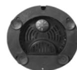
Dyspenser RCSS-3 jest wyposażony w dodatkowy regulator temperatury, który znajduje się pod spodem urządzenia. Służy on do regulacji maksymalnej temperatury płytki grzewczej. Termostat jest skalibrowany fabrycznie a jego ustawienie nie powinno być zmieniane. Zmiana tego ustawienia będzie miała wpływ na czas grzania produktu.
