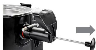
Odšroubujte dva šrouby (1) a vytáhněte pružinu (2) z otvoru. Celý vypouštěcí ventil lze v tuto chvíli vyndat ze zařízení:
